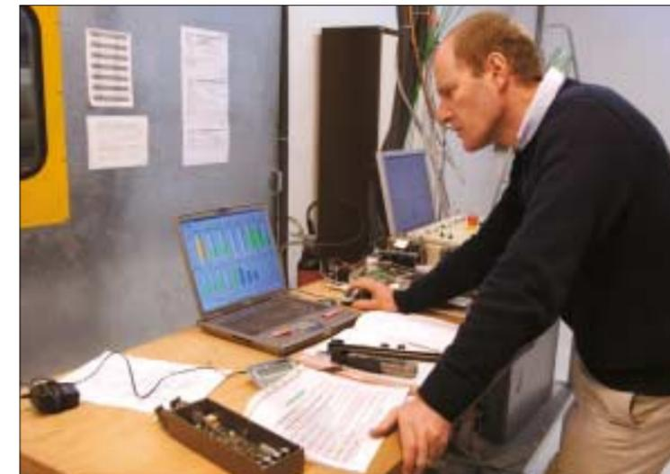
Réglage des cartographies moteur au banc par Gordon Anderson. Au premier plan, boîtier abritant l'un des calculateurs d'injection d'allumage numérique DEM.
