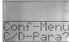
Fig. 28 : Configuration des paramètres de charge/décharge
