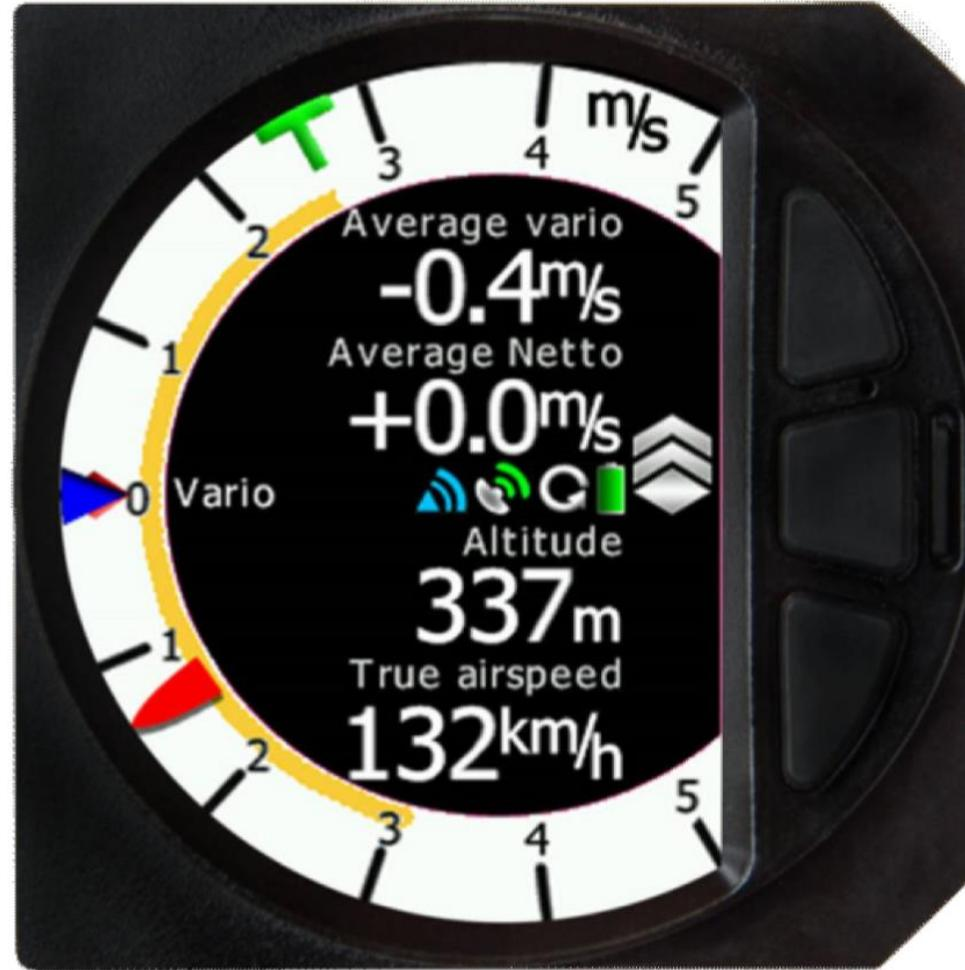
L'écran principal de cet indicateur est divisé en 2 parties : une couronne blanche avec une aiguille (une échelle de type vario) et un écran central avec 4 Navbox modifiables. En appuyant sur le bouton central, vous basculez l'afficheur de ce mode vers un mode radar Flarm (si un Flarm est relié au LX ou intégré au LX) et un horizon artificiel (en option).
